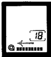
1. Während der Rückspulung des Films "fließen" die Skalen auf dem LCD-Monitor und im Sucher von rechts nach links und zeigen so die Film-Rückspulung an. Gleichzeitig zählt das Bildzählwerk rückwärts.
