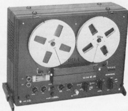
Falls die automatische Abschaltung kurz nach dem Start des Bandlaufes anspricht, weil die Schaltfolie am Anfang des Tonbandes sich noch im Bandführungsschlitz befand, wird der Bandlauf durch Weiterdrehen des Funktionswählers ③ über die Stellung „START“ hinaus in Gang gesetzt. Nach Freigeben des Bedienungsriffes springt dieser selbsttätig in die Stellung „START“ zurück.
